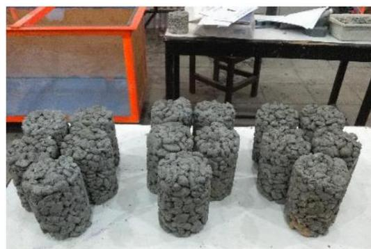
Gambar 3. Sampel Uji dengan tiga variasi gradasi agregat
