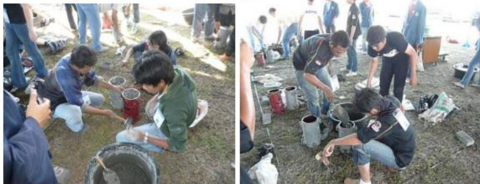
Gambar 2. Proses pembuatan spesimen beton porus
