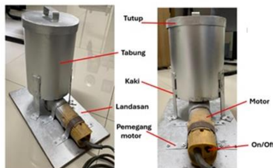
Gambar 3. Mesin Pencacah Tutup Botol Plastik Sederhana
