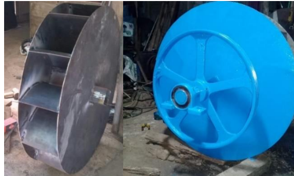
Gambar 6. Konstruksi turbin dengan pulley
