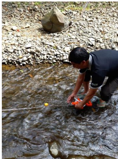
Gambar 2. Pengukuran kecepatan air
